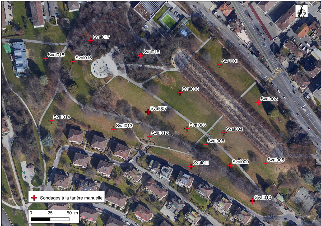
Figure 35 : Implantation des sondages au parc de Valency (18 sondages).
