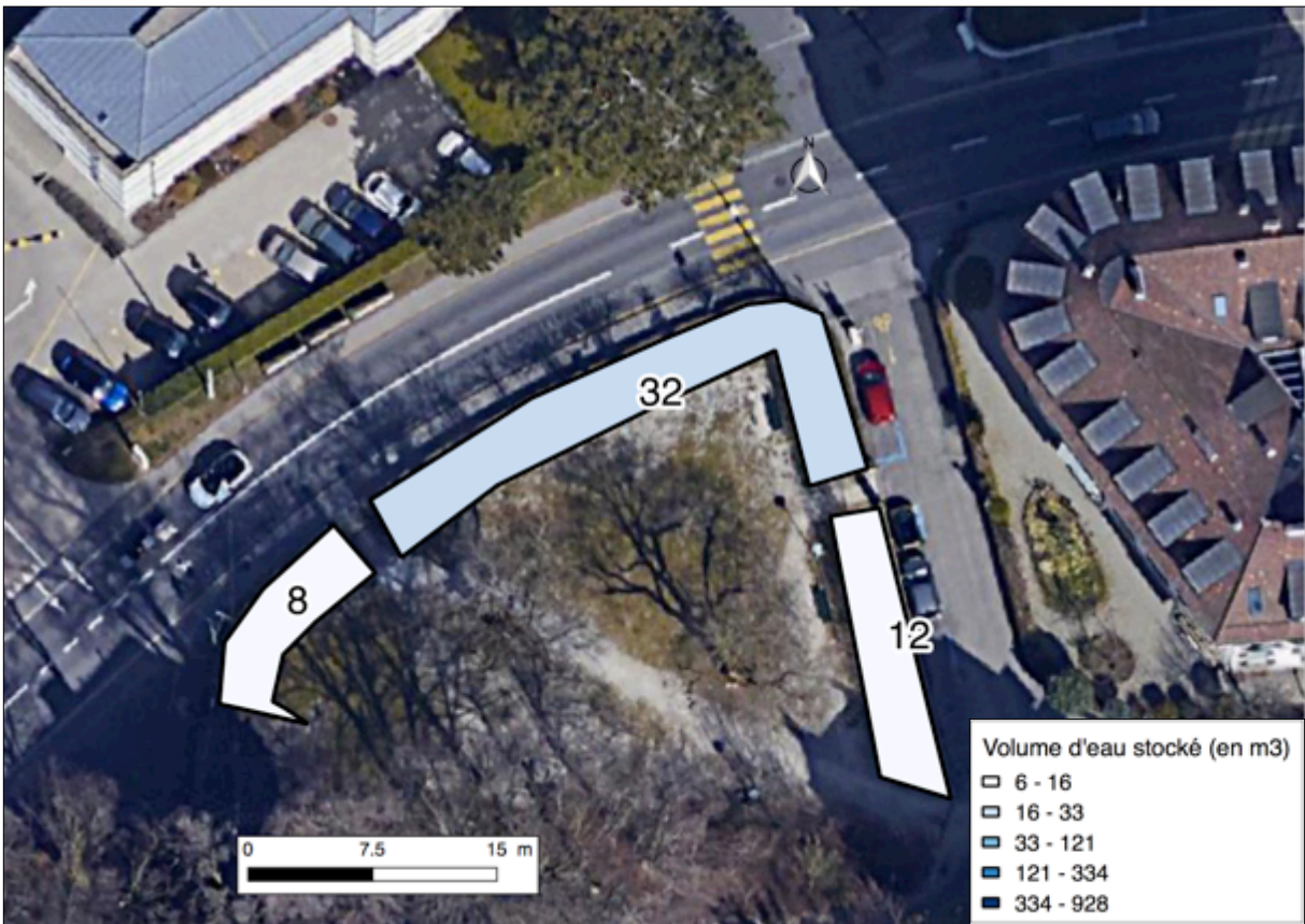
Figure 8 : Volume maximal d'eau (en m 3 ) stocké par les sols du square de Montétan.
